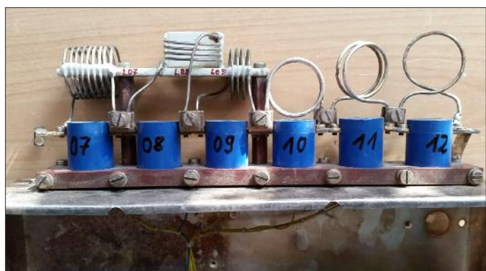
Bild 5: Anordnung der Spulen der L-Dekade
